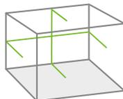
L'X2 GREEN autolivellante risulta particolarmente utile nell'allestimento di interni grazie alla precisione delle sue linee guida e all'eccellente visibilità. Il laser a linee proietta una linea laser verde orizzontale e una verticale con una tolleranza di misurazione di  $\pm 0,2$  mm/m. La finestra laser di grandi dimensioni permette di avere linee laser in un range di  $170^\circ$  per un gran numero di lavori su pavimenti, soffitti e pareti.
