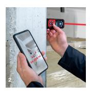
1) La fotocamera per ricerca del target con zoom 2x e 4x consente di rilevare meglio il punto di misurazione e permette di visualizzare con esattezza l'oggetto tramite il punto di bersaglio ottico in sovrimpressione.
