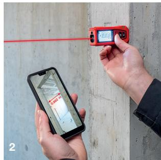
1) La fièle intégrée dans le METRON 30 BT est particulièrement utile. Elle permet de positionner l'appareil correctement en cas de mesures horizontales. L'avantage : des résultats de mesure plus précis.
